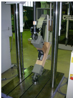
仕口単体の振動実験
