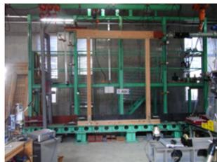
木造軸組単位フレーム (W1,820mm x H2,730mm) の実大実験
